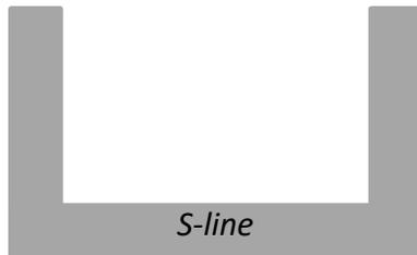
Il profilo **SL ON 9** si utilizza semplicemente per creare travature sui soffitti, molto utilizzati per realizzare controsoffitti a cassettoni ottenuti da un insieme di riquadri che, se ulteriormente decorati al loro interno rendono il soffitto di un'eleganza unica.
