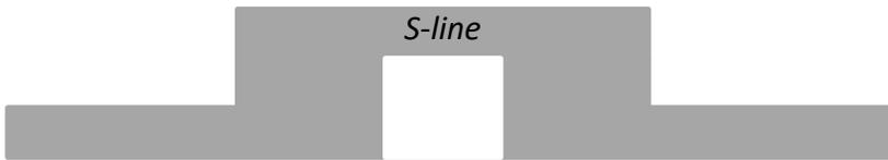
Il profilo **SL OS 7** è stato pensato per installare streep led di alta potenza e ottenere quindi un'elevata luminosità, con inserito il dissipatore in alluminio già dotato di cover in PPMMA da applicare su superfici piane, offre una notevole intensità di luce poiché la luce è diretta.
