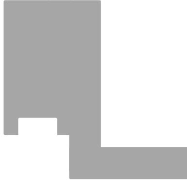
Il profilo *SL OS 8* nasce per mettere in risalto la parete adiacente, ci si può installare una streep led di alta potenza e ottenere quindi un'elevata luminosità, si applica sugli angoli, tra parete e soffitto o anche tra 2 pareti.
